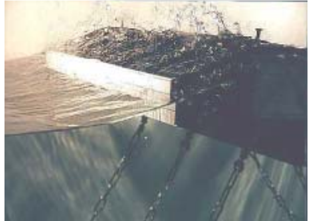
写真-3 トラス構造による砕波の様子
