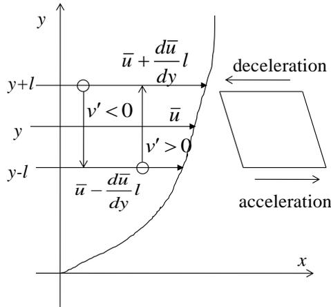
図-1 乱れによる運動量の輸送 (レイノルズ応力)
