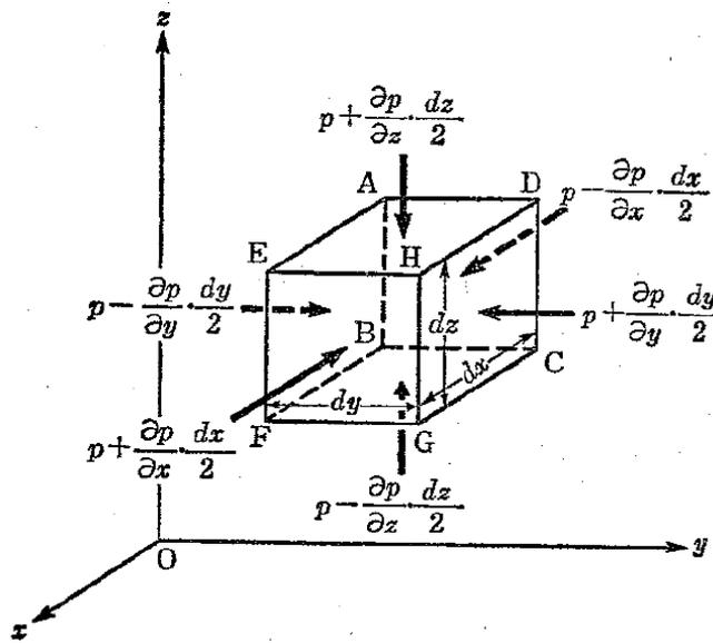
図-3 微小直方体に作用する圧力
