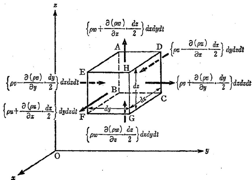
図-2 微小直方体への流体の流出入
